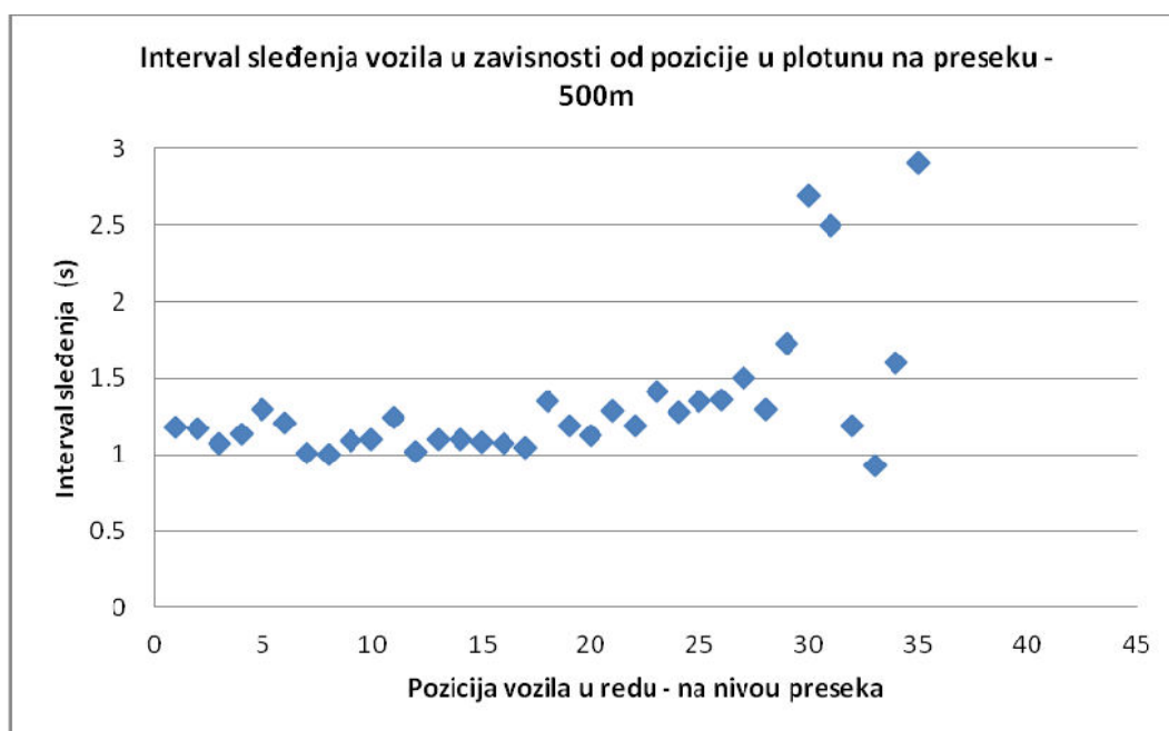
Slika 5-12 Interval sleđenja vozila u zavisnosti od pozicije vozila u plotunu posmatrano na drugom preseku (500m)
