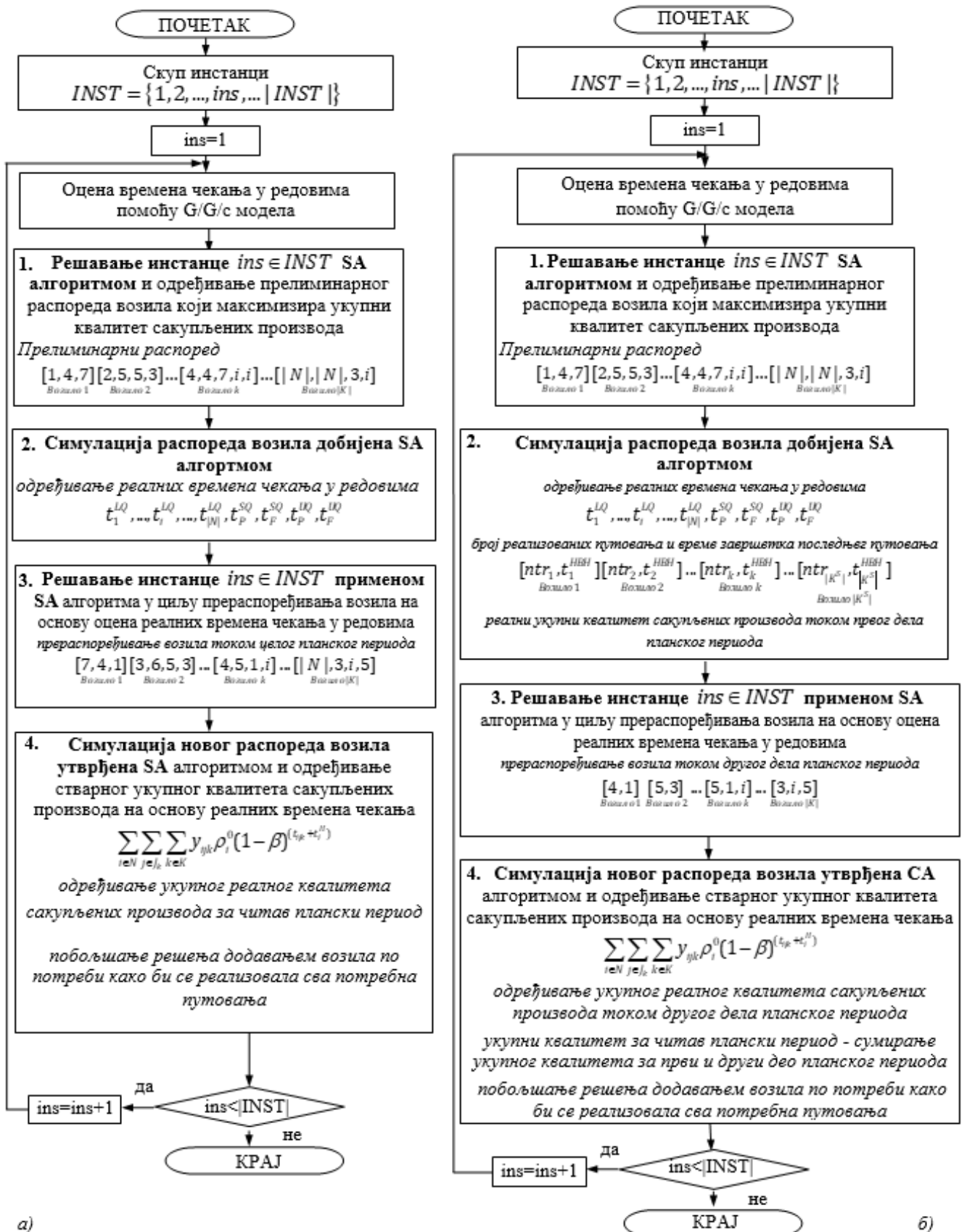
Слика 5 Дијаграми тока којима је представљена примена DBD (а) и HBH (б) хибридног приступа оптимизацијом и симулацијом [86]
