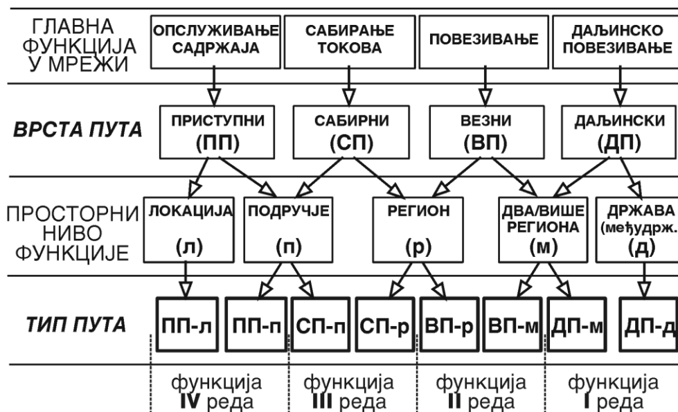
Слика 3.1. Врсте и типови путева према функционалној класификацији (Tubić & Maletin, 2008)
